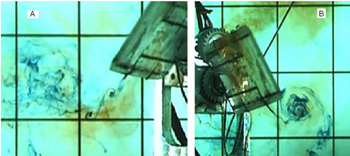
Rysunek 6.2-5. Wir krawędzi splywu dla różnych zredukowanych częstotliwości \Phi=160^\circ (A), \Phi=60^\circ (B) przy liczbie Reynoldsa=3500
