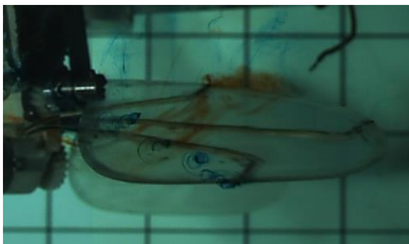
Rysunek 6.4-2. Struktury wirowe przy dużych kątach natarcia
