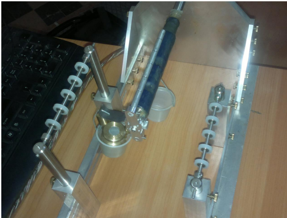
Rysunek 5.1-4 Waga tensometryczna podczas kalibracji
