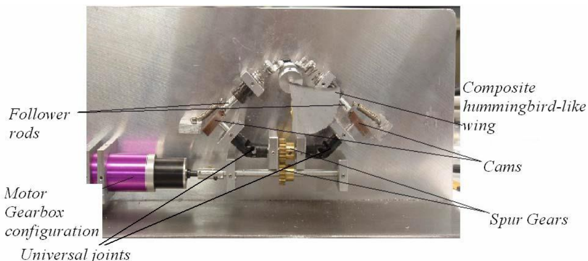
Rysunek 2.5-14. Układ napędowy oparty na mechanizmie krzywkowym
