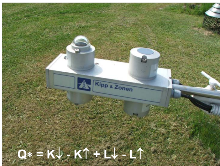
Fot. 3.1. Pyranopyrgeometr CNR-1 używany we Wrocławiu-Swojcu do pomiarów składowych ( K_{\downarrow} , K_{\uparrow} , L_{\downarrow} , L_{\uparrow} ) całkowitego bilansu promieniowania Q^* różnych powierzchni czynnych Phot. 3.1. Pyranopyrgeometer CNR-1 used in Wrocław-Swojec in the measurements of the radiation balance Q^* components ( K_{\downarrow} , K_{\uparrow} , L_{\downarrow} , L_{\uparrow} ) of different active surfaces
