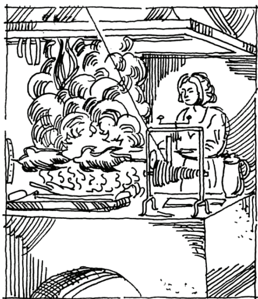
Rys. 259. Pies w kole deptakowym obracający rożna przy kominku. Rys. autora na podst.: [F. Lesile z 1869 r., Baden-Powell 2005: 3; Campbell-Franklin 2003: 274]
