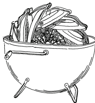
Rys. 221. Urządzenie do mycia talerzy zawieszonych na obrotowych uchwytych poruszanych korbą. Rys. autora na podst.: [Haselsteiner 2000: 28]
