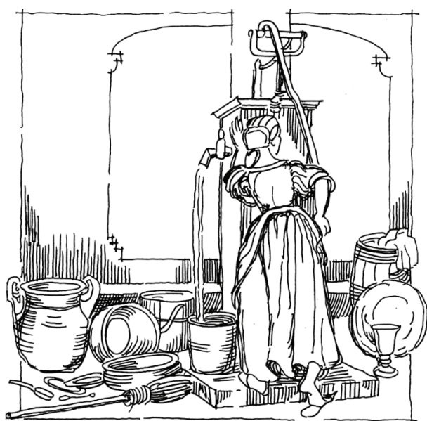
Rys. 207. Pompa kolumnkowa z drewnianą obudową z XVI/XVII w. Rys. autora na podst.: [Harrison 1972: 60]
