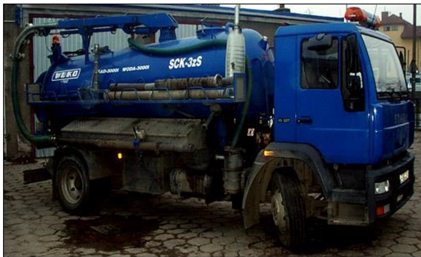
Fot. 3. Samochód specjalny ssąco-płuczący typu SCK-3zS (firmy WUKO)
