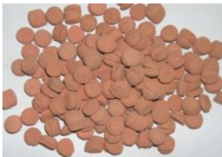
Rys. 3. Katalizator wapniowy zastosowany w procesie
