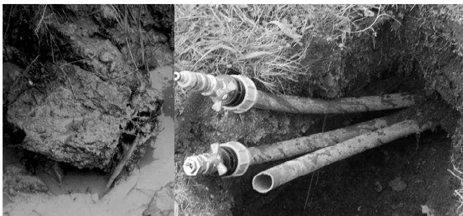
Rys. 5. Sondy gruntowe wprowadzone do odwiertów
