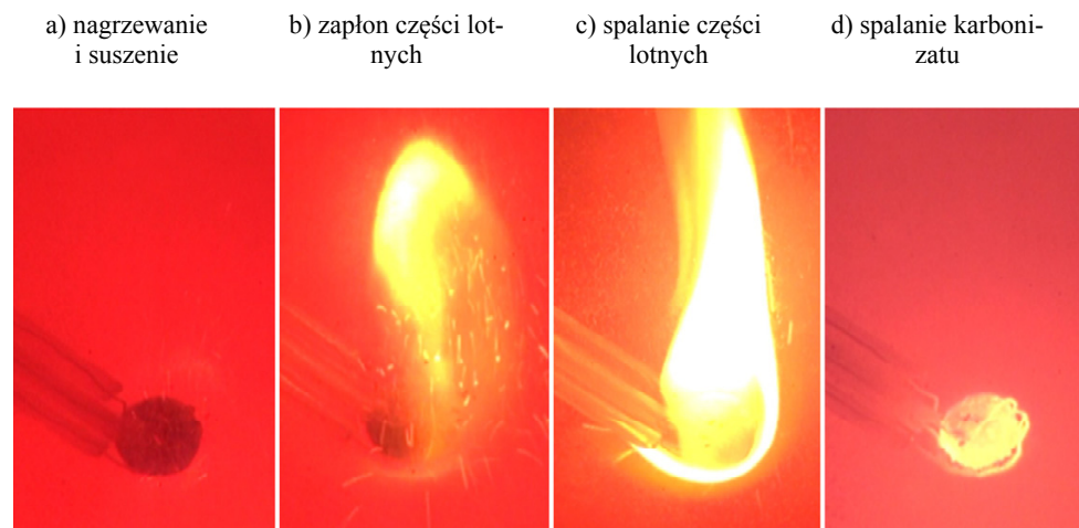
Rys. 4. Etapy spalania brykietu z biomasy agro w CWF w temperaturze 850 °C
