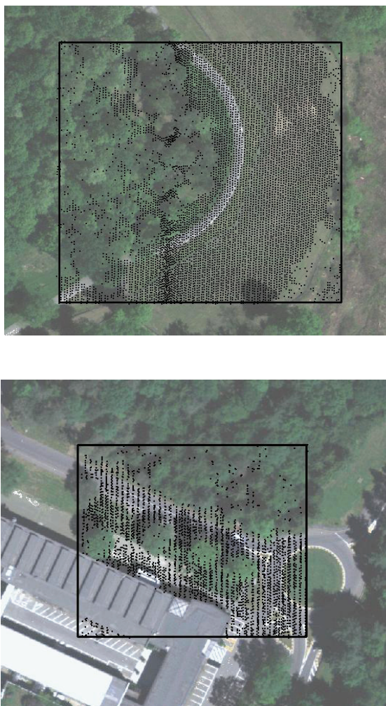
Ryc. 4. Punkty klasy Ground (dane ALSowe) na tle ortofotomapy Fig. 4. Ground points (ALS data) on the orthophotomap background
