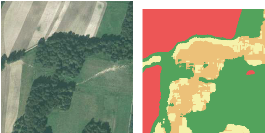
Rys. 2.2. Zdjęcie lotnicze: obraz pierwotny (l) i wynik segmentacji (p) [GUGiK].
