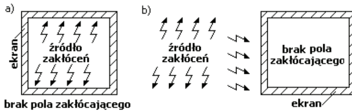
Rys. 8.1. Sposoby ekranowania: a) ekranowanie lokalizujące, b) ekranowanie osłaniające [257]
