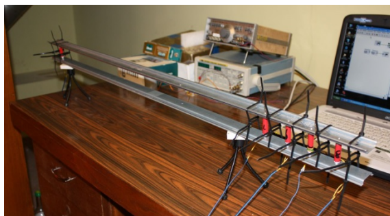
Rys. 8.5. Stanowisko do transmisji mocy elektrycznej i danych przez drgania mechaniczne [118, 119, 126–128]
