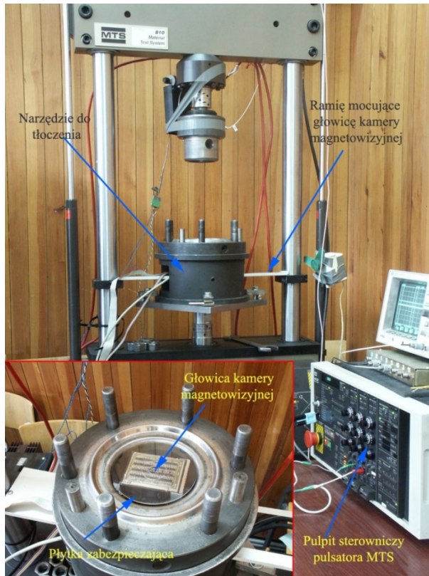
Rys. 7.93. Widok stanowiska badawczego z wykorzystaniem kamery magnetowizyjnej [63, 96]
