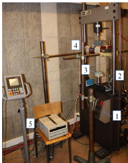
Rys. 2.14. Stanowisko badawcze do badań właściwości magnetomechanicznych kompozytów magnetoreologicznych: 1 – pulsator MTS, 2 – układ regulacji pola magnetycznego, 3 – czujnik siły, 4 – układ magnetyczny wraz z zamontowaną próbką, 5 – zasilacz regulowany [20]
