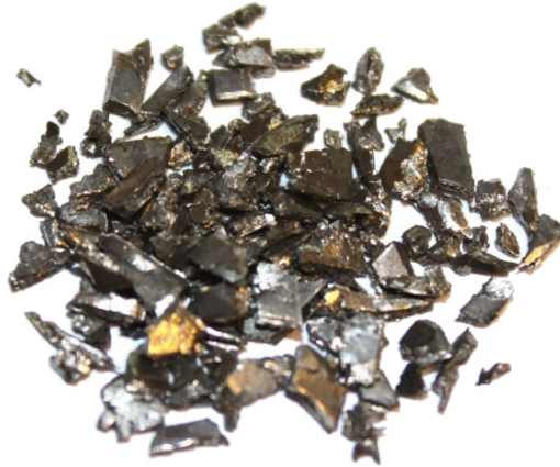
Rys. 5.6. Wypełnienie łoża magnetycznego – kawałeczki gadolinu [12, 13]
