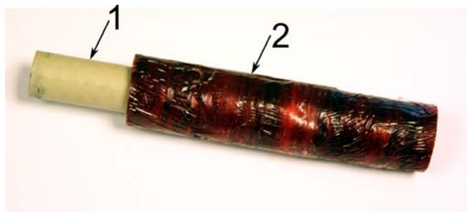
Rys. 4.3. Forma zastosowana do wytwarzania kompozytu: 1 – tuleja z PVC (część uszczelniająca), 2 – obudowa kompozytowa (część wytrzymałościowa) [66]
