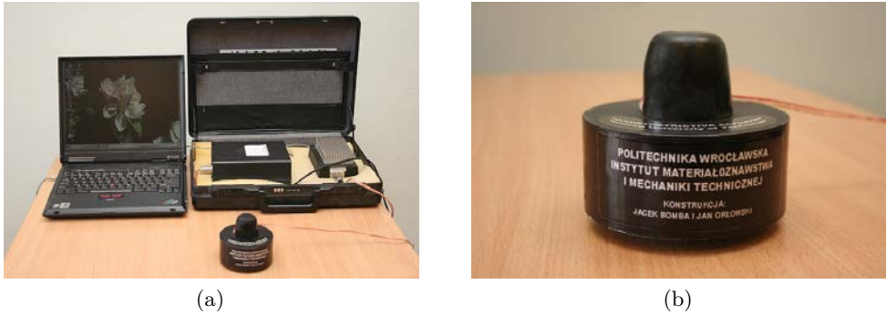
Rys. 3.16. Prototypowy generator drgań akustycznych (konstrukcja własna) [1]
