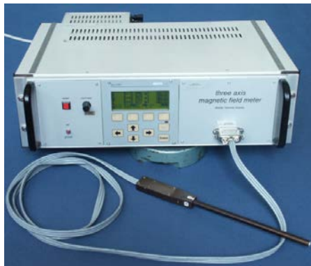
Rys. 7.22. Precyzyjny trójosiowy hallotronowy przyrząd do pomiaru natężenia pola magnetycznego i strumienia indukcji wykonany w Politechnice Wrocławskiej
