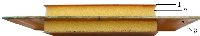
Rys. 2.8. Próbka do badania MRC w warunkach cyklicznego ścinania: 1 – cienki laminat umożliwiający zamontowanie próbki w szczelinie elektromagnesu, 2 – materiał porowaty stanowiący matrycę kompozytu, 3 – płytka nośna [20]
