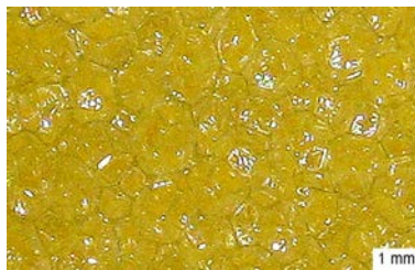
Rys. 2.7. Struktura porowata gąbki poliuretanowej o średniej wielkości porów równej 1 mm [20]
