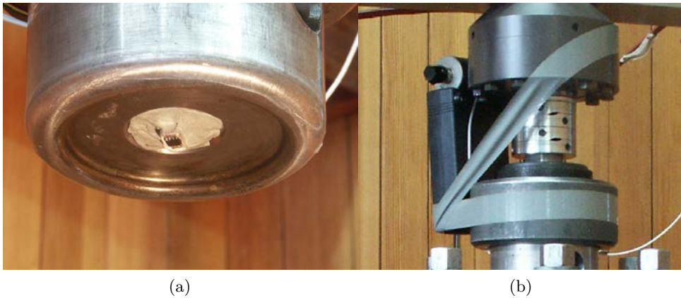
Rys. 7.91. a) widok sensora pola magnetycznego umieszczonego w środku stempla, b) układ pomiarowy pola magnetycznego umieszczony w pobliżu sensora [63, 96]
