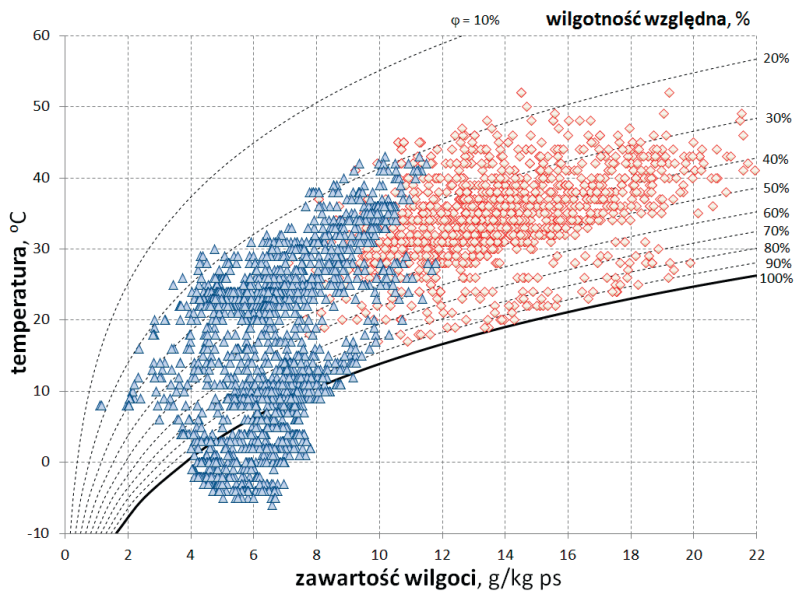
Rys. 5.5. Rozkład warunków mikroklimatycznych jakie panują w pomieszczeniu pracy silnika SE-1 na wykresie psychrometrycznym w układzie prostokątnym x-t , dane zgromadzone w okresie 28.08.2009 r. – 31.01.2012 r.
