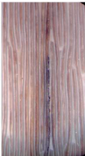
Rys. 2.7. Wpływ oddziaływań termomechanicznych na skrócenie czasu życia izolacji: a) struktura izolacji z rozwarstwieniem, b) prawdopodobieństwo wystąpienia uszkodzenia [30]
