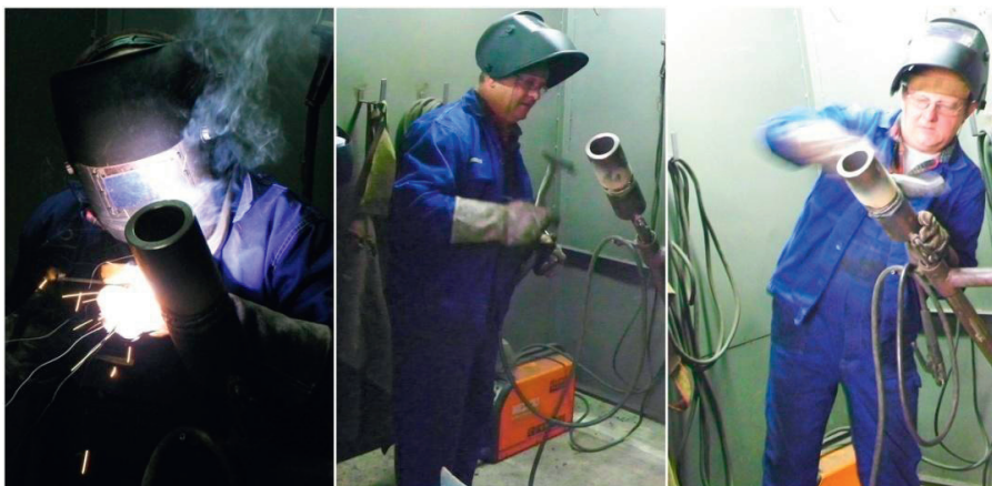
Rys. 3. Spawanie elektrodami otulonymi, oczyszczanie młotkiem i szczotką drucianą
