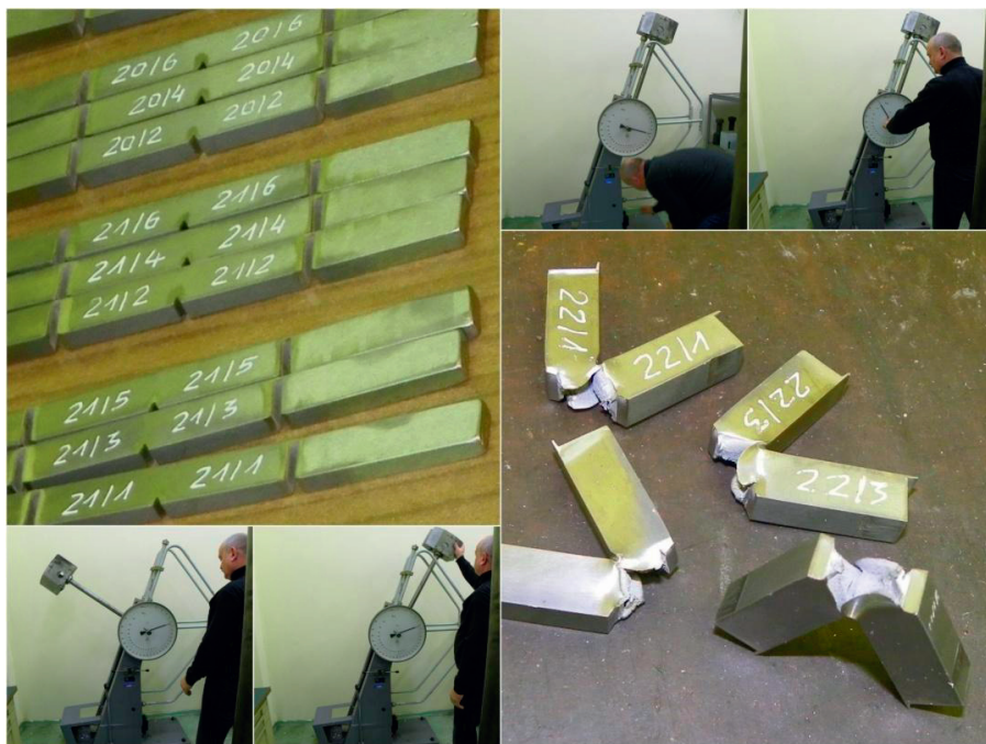
Rys. 12. Próbkę podczas badania udarności młotem Charpy'ego
