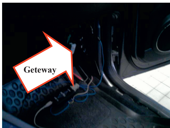
Rys. 8. Miejsce występowania mostka łączącego w samochodzie Mercedes – Benz B180
