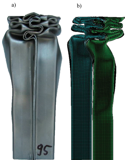
Rys. 10.3. Postać końcowa zgrzewanej struktury DH grubości 1,2 mm – stal DP 600: a) eksperyment, b) symulacja
