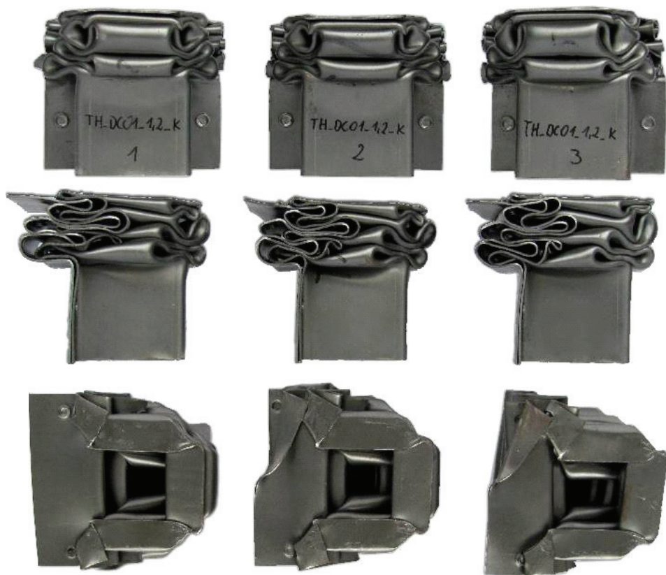
Rys. 9.19. Postać elementów po dynamicznej próbie zgniatania – struktury klinczowane TH DC01 1,2 mm
