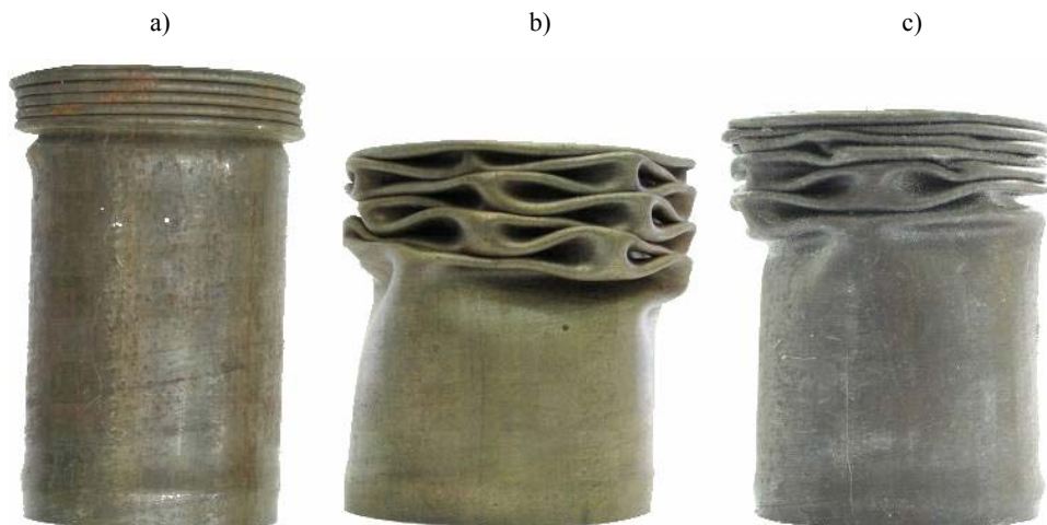
Rys. 5.1. Sposoby deformacji profili okrągłych zgniatanych osiowo: a) postać osiowosymetryczna, b) postać niesymetryczna, c) postać mieszana
