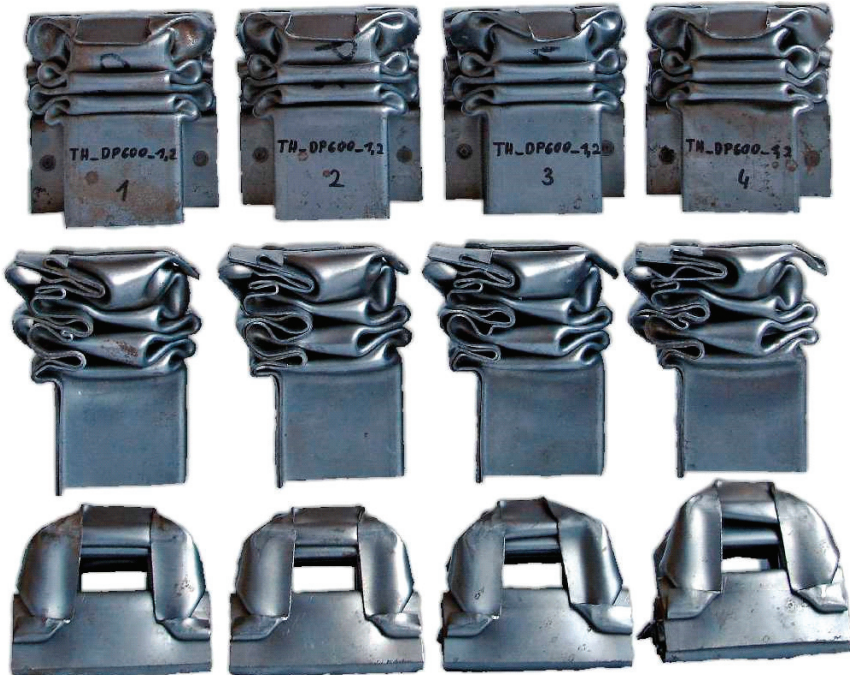
Rys. 9.9. Postać elementów po quasi-statycznej próbie zgniatania – struktury zgrzewane TH DP600 1,2 mm
