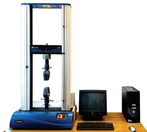
Rys. 7.3. Stanowisko badawcze do quasi-statycznego zrywania próbek
