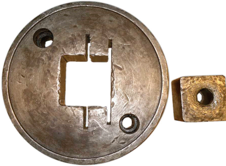
Rys. 9.5. Płyta ustalająca do badań quasi-statycznego zgniatania elementów energochłonnych
