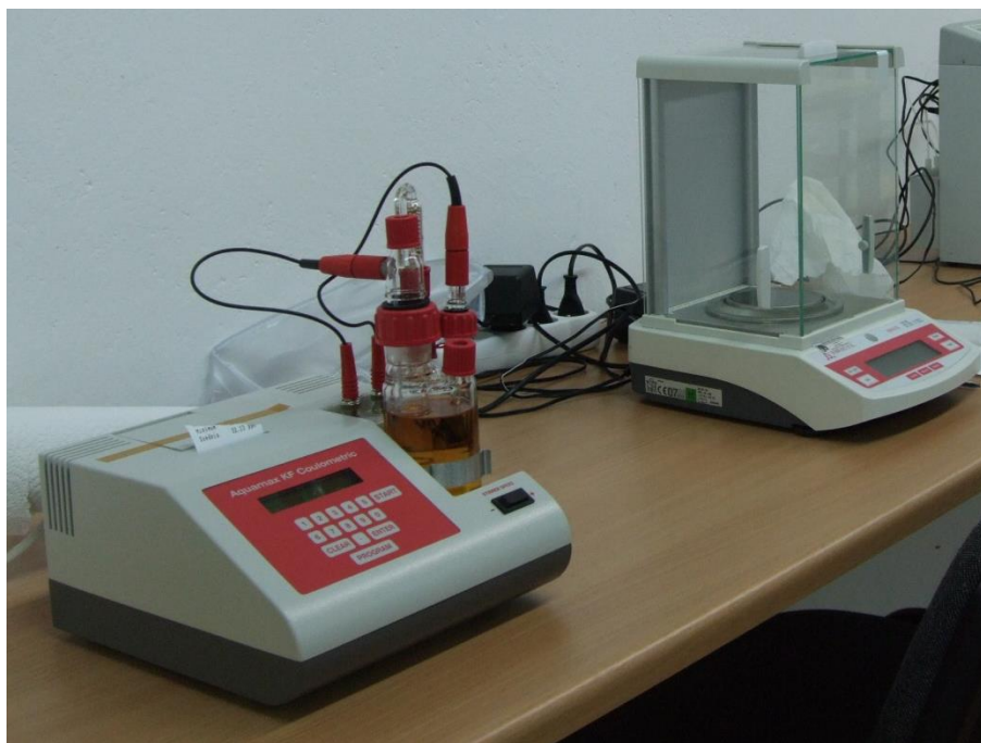
Rys. 5.1 Zdjęcie stanowiska pomiarowego – model AquaMax KF firmy GRScientific
