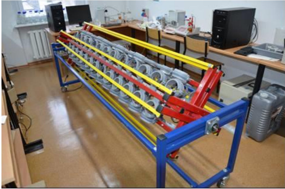
Rys. 6.1 Mieszarka automatyczna użyta do rozpuszczania fullerenów C_{60} w oleju
