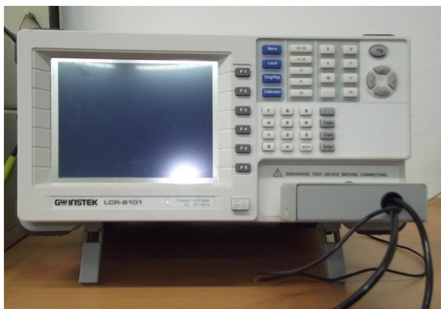
Rys. 5.4 Mostek RLC LCR-8101G wykorzystany w pomiarach.
