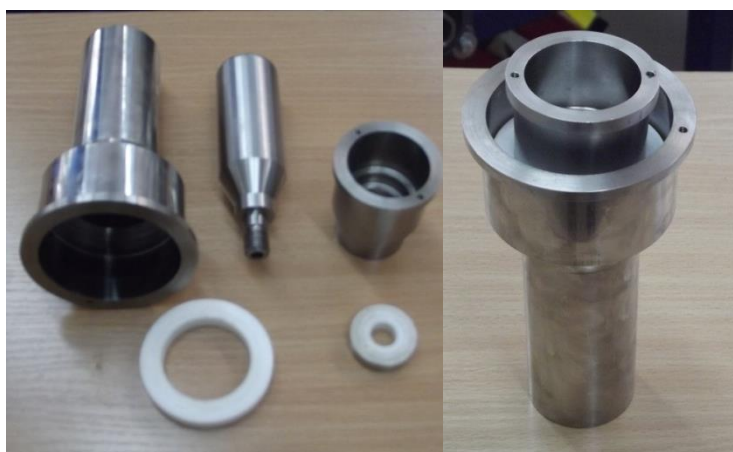
Rys. 5.6 Budowa kondensatora pomiarowego trójelektrodowego wykorzystanego w badaniach.
