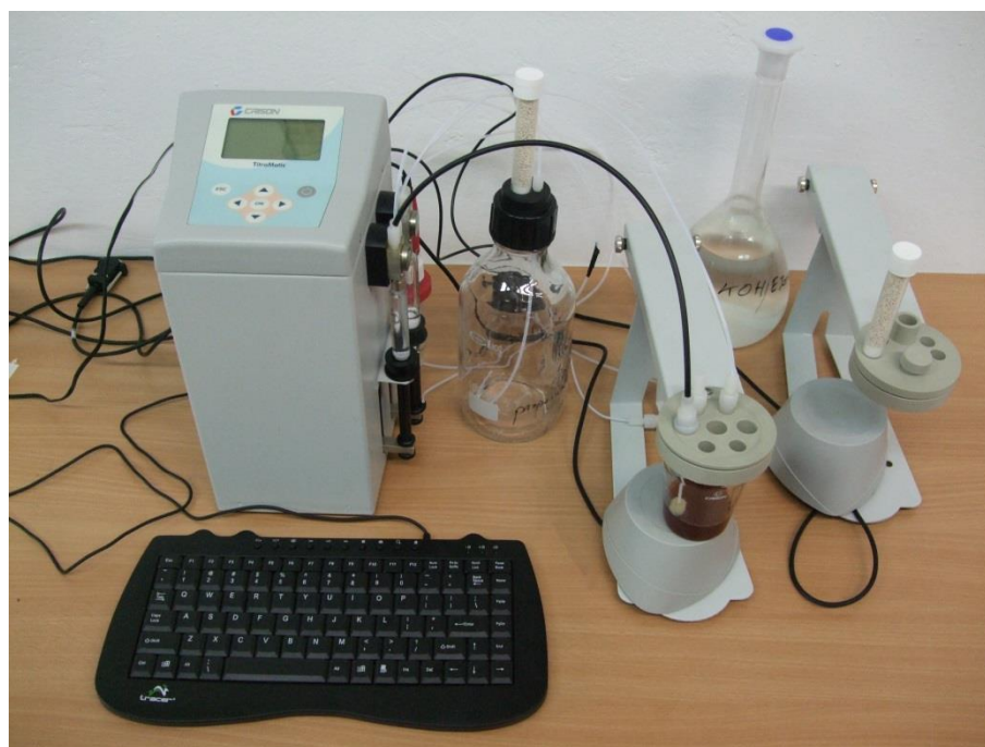
Rys. 5.2 Zdjęcie stanowiska pomiarowego - TrioMatic 2S firmy Crison
