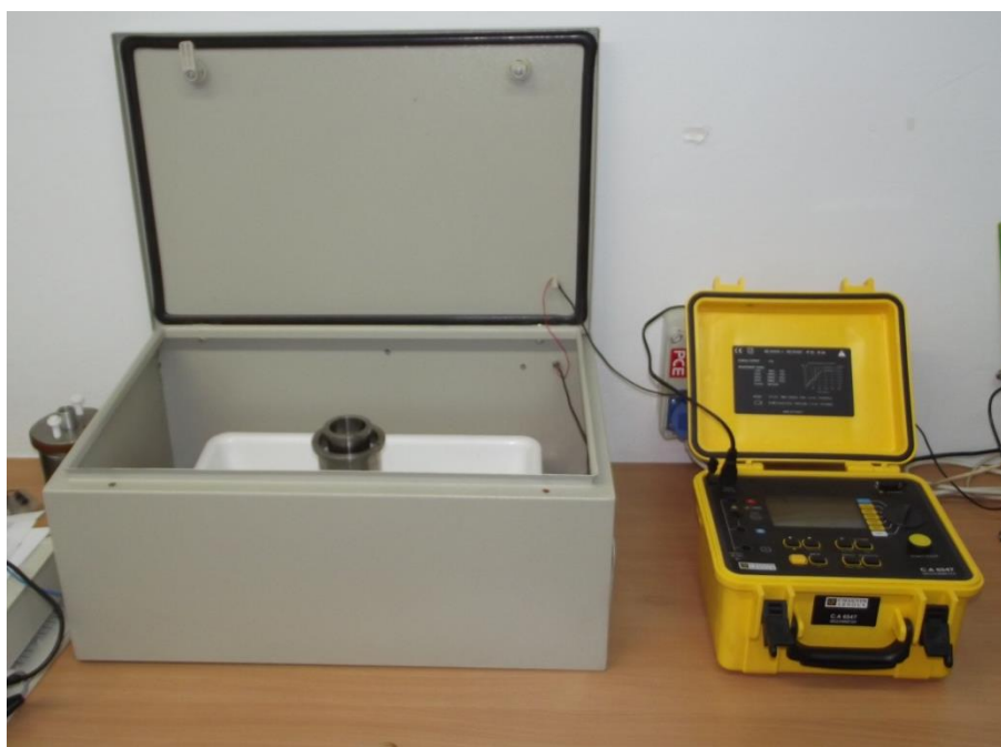
Rys. 5.5 Cyfrowy miernik rezystancji izolacji 5kV. Model C.A. 6547
