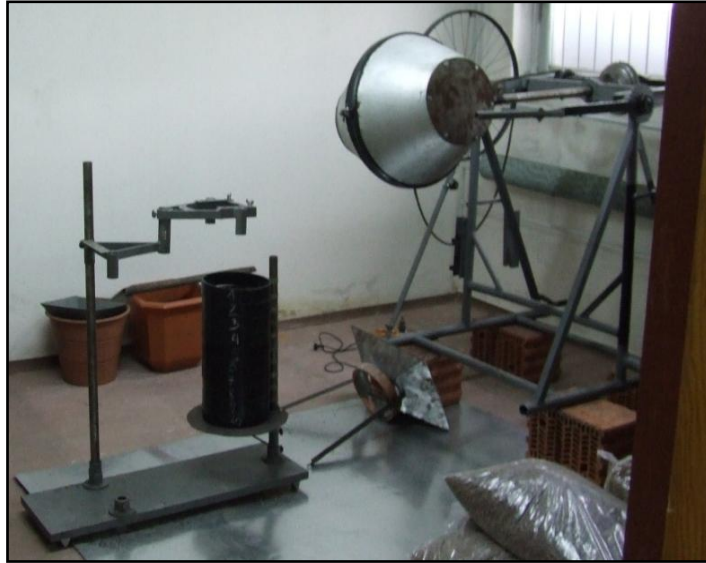
Rys. 20 – Mieszalnik obrotowy dwustożkowy oraz stanowisko do poboru próbek
