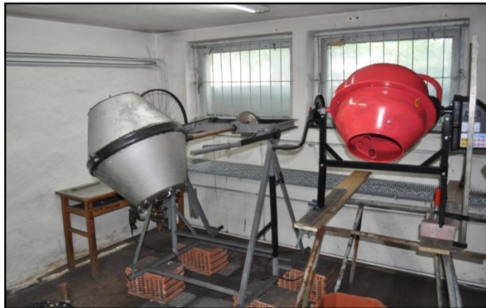
Rys. 21 – Mieszalniki obrotowe wykorzystywane podczas badań.
