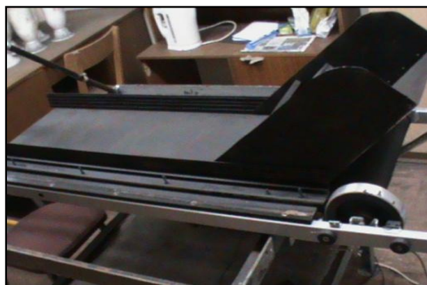
Rys. 22 - Trzeci moduł stanowiska badawczego - taśmociąg
