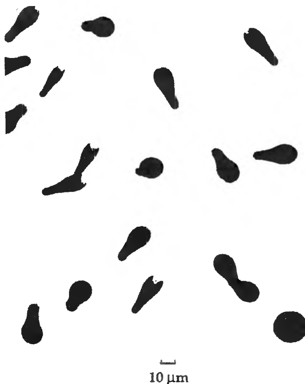
Rys. 8. Mikrofotografia typowych wżerów od radonu na powierzchni folii CR-39, trawionych standardowo
