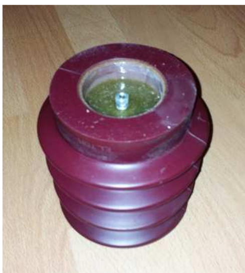
Rys. 7.5. Kondensator do pomiaru wzn silnika na napięciu U=6\text{kV}
