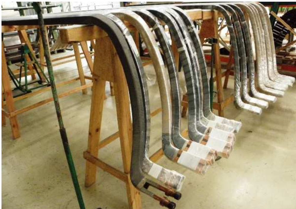
Rys. 5.6. Pręty uzwojenia stojana generatora TWW-230-2
