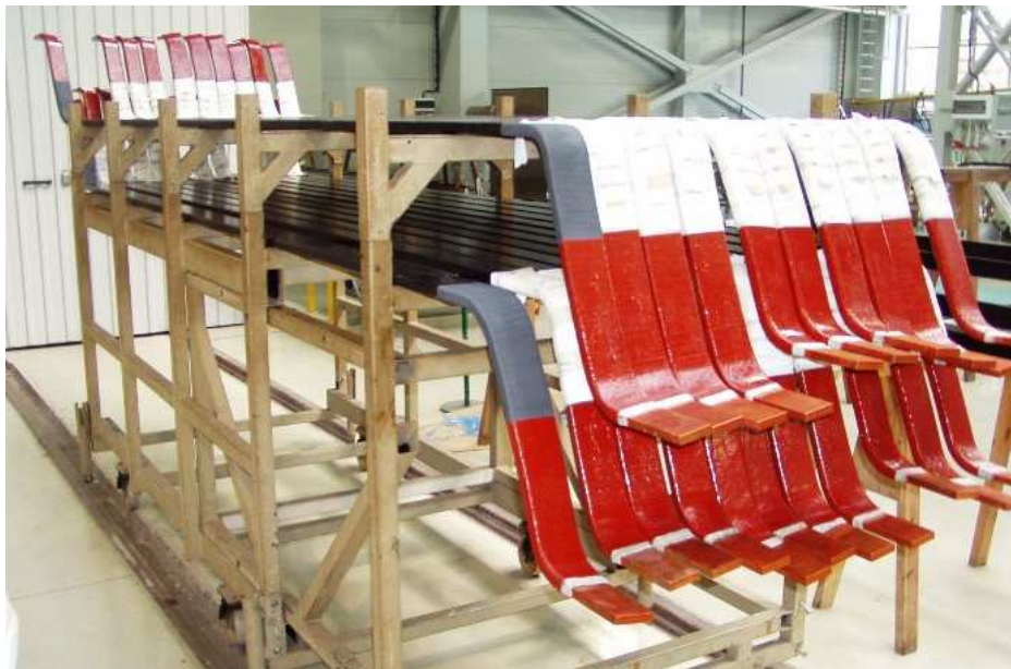
Rys. 5.18. Pręty stojana hydrogeneratora GDH 7262S -12
