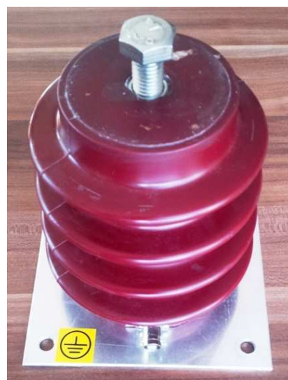
Rys. 7.5. Kondensator do pomiaru wzn silnika na napięciu U=6\text{kV}
