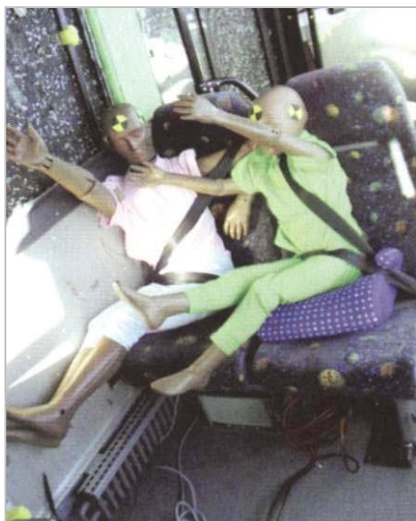
Rys. 156. Sytuacja wewnątrz autobusu podczas testu przewracania się na stoku
