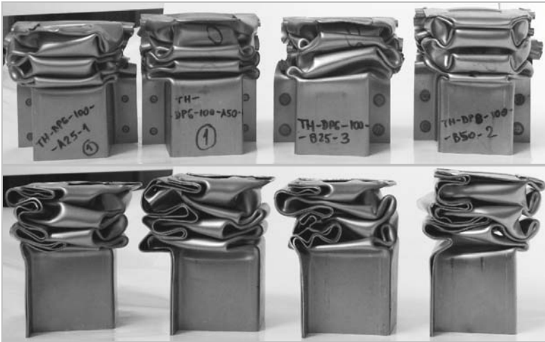
Rys. 103. Deformacja profili kapeluszkowych – grubość blachy t = 1,0 mm (widok z przodu i z boku)
