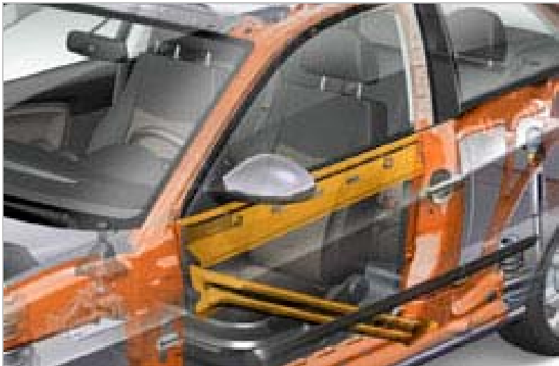
Rys. 131. Wzmocnienie boczne ściany i drzwi samochodu
