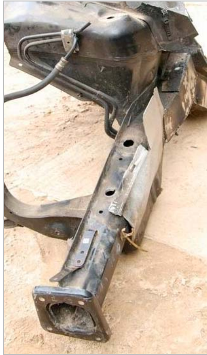
Rys. 126. Rozwiązanie konstrukcyjne podłużnicy w Audi A4
