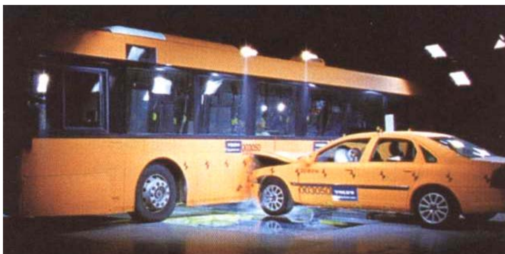
Rys. 159. Test na zderzenie boczne autobusu z samochodem osobowym
