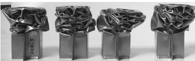
Rys. 94. Końcowa postać zgniotu belek cienkościennych – grubość blachy t = 0,8 mm: a) widok z przodu, b) widok z boku
