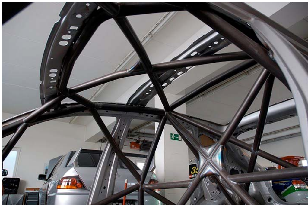
Rys. 141. Zamontowana „klatka bezpieczeństwa” w samochodzie Mitsubishi Lancer Evo
