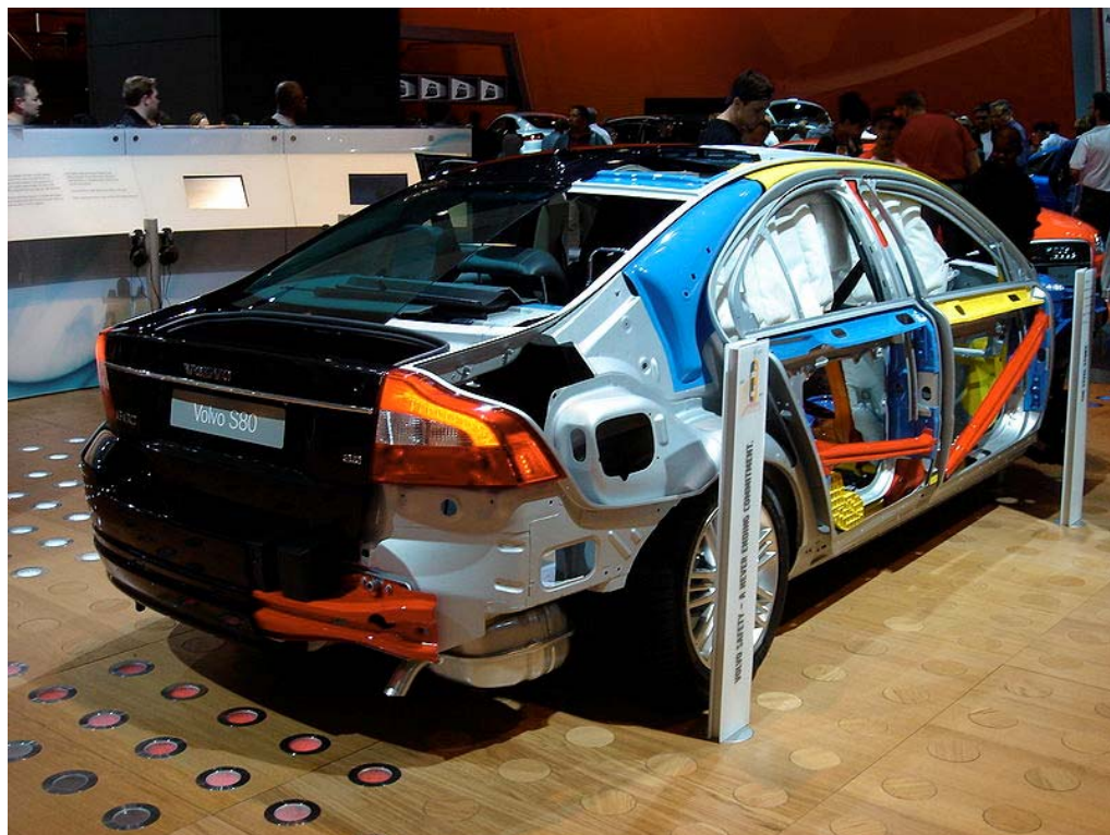
Rys. 135. Szczegóły wzmocnienia bocznego w samochodzie Volvo S80
