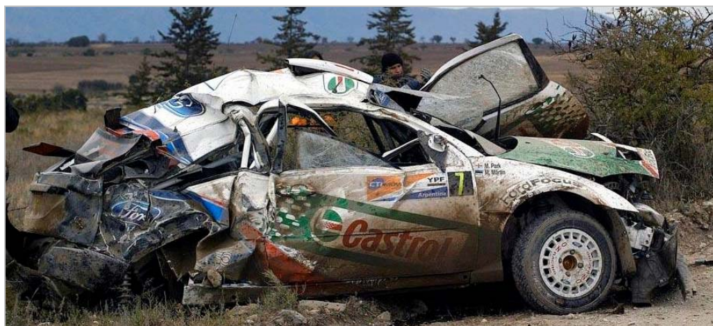
Rys. 146. Widoczna nienaruszona przestrzeń życiowa po dachowaniu z prędkością 150 km/h (Ford Focus WRC). Obrażenia: wstrząs mózgu i potłuczenia
