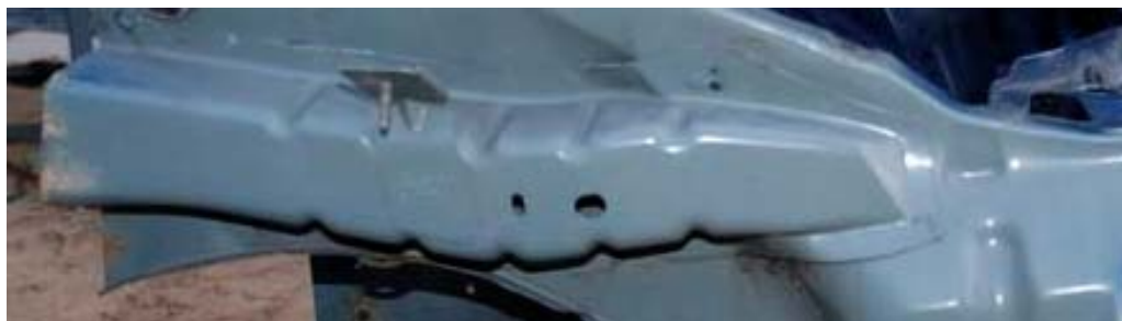
Rys. 123. Podłużnica samochodu marki Renault Scenic I
