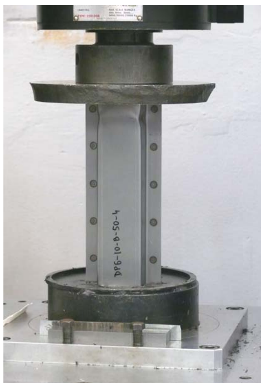
Rys. 66. Próbką przygotowana do ściskania w Zakładzie Wytrzymałości Materiałów Politechniki Wrocławskiej
