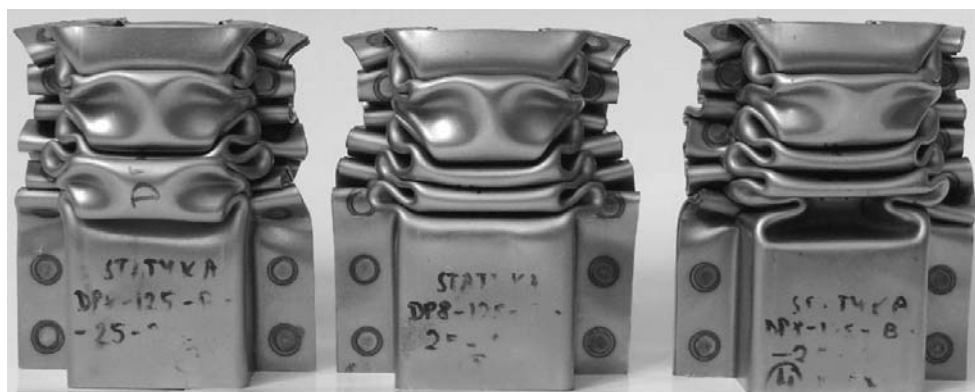
Rys. 97. Taka sama deformacja DH_DP800_125x25x8
