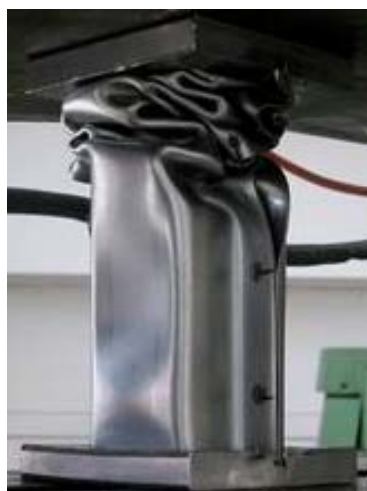
Rys. 11. Belka zgniatana: a) bez inicjatora, b) z imperfekcją wstępną [85]
