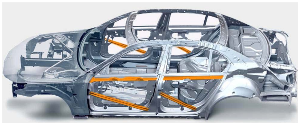
Rys. 136. Wzmocnienia boczne zastosowane w nadwoziu i drzwiach samochodu marki BMW
