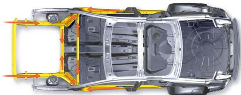
Rys. 122. Struktura nośna Volvo S40/V50 zapewniająca osiowy rozkład sił zderzenia [114]
