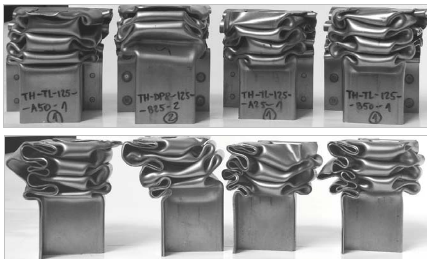
Rys. 102. Deformacja profili kapeluszowych – grubość blachy t = 1,25 mm (widok z przodu i z boku)
