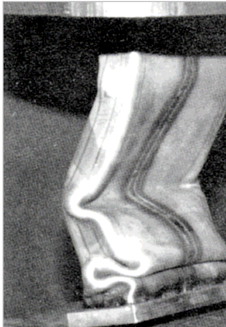
Rys. 10. Globalne wyboczenie kolumny prostokątnej o małym stosunku szerokości boków [114]
