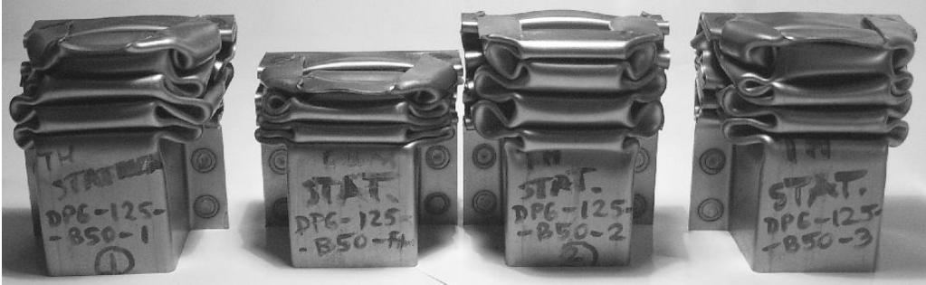
Rys. 107. Deformacje belek cienkościennych dla serii TH_DP600_125×50×8
