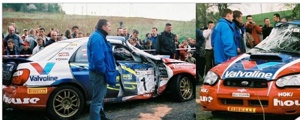
Rys. 144. Odształcenie klatki i karoserii po nadsterownym poślizgu (195 km/h), i odbiciu się od drzewa z prędkością ok. 100 km/h. Obrażenia: pęknięte żebra u pilota
