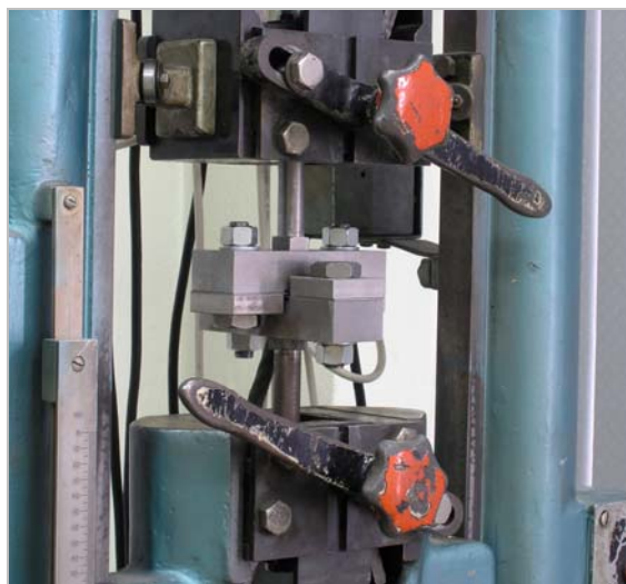
Rys. 47. Paski blach połączonych punktowo zamocowane w uchwytach mocujących maszyny wytrzymałościowej przed próbą na rozciąganie krzyżowe
