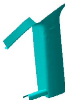
Rys. 190d. Osłona wzmocnienia – model geometryczny
