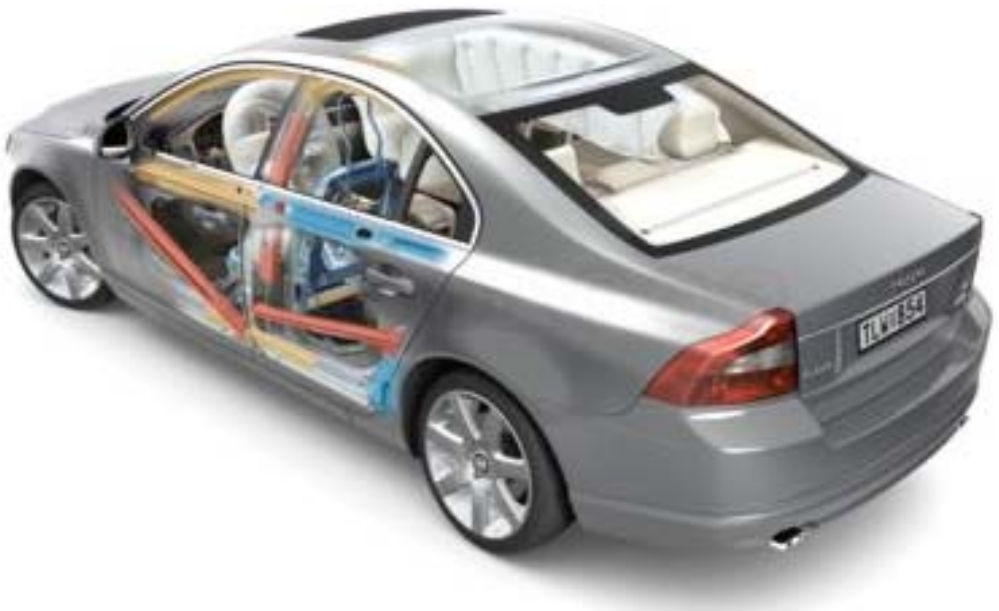
Rys. 134. Stosowane wzmocnienie boczne samochodu marki Volvo
