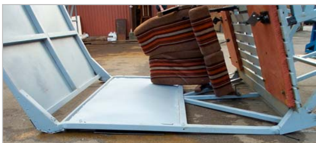
Rys. 157. Przewrócenie się modułu autobusu bez manekinów
