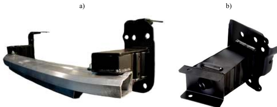
Rys. 120. Elementy energochłonne w Audi Q7: a) podłużnice połączone z elementami typu crash-box, b) podłużnica z wstępnymi przetłoczeniami
