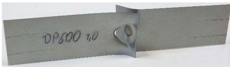
Rys. 45. Postać deformacji i zniszczenia zgrzanych punktowo pasków blach otrzymane w wyniku przeprowadzonego testu na ścinanie
