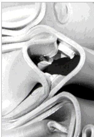
Rys. 87. Rozerwanie połączonych kołnierzy na skutek niewłaściwego doboru rozstawu zgrzein [98]
