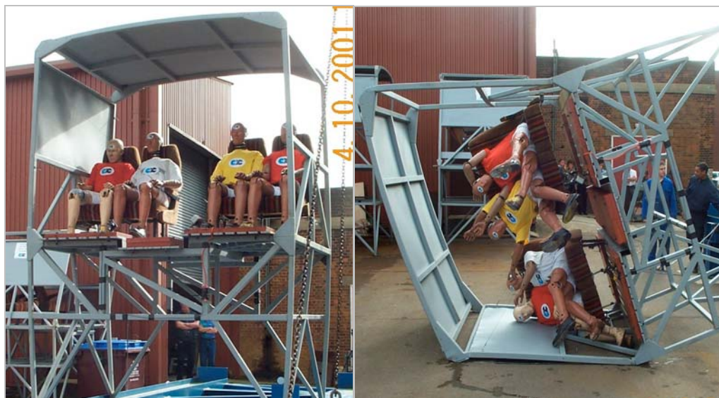
Rys. 158. Przewrócenie się na bok modułu autobusu z manekinami
