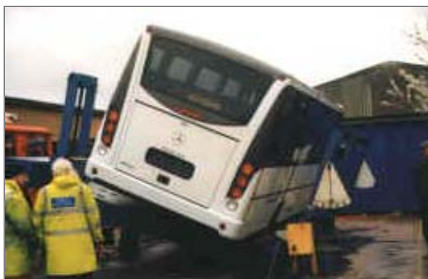
Rys. 154. Upadek autobusu z rampy o wysokości 0,8 m na beton wg ECE R66: a) widok z przodu, b) widok z boku
