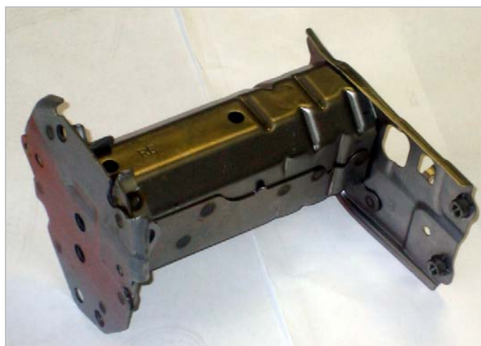
Rys. 125. Szereg przetłoczeń w podłużnicy samochodowej
