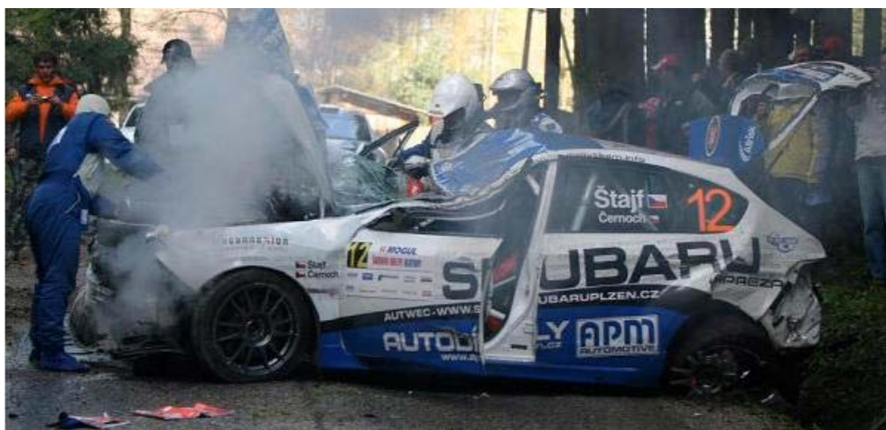
Rys. 147. Zdeformowana klatka po uderzeniu dachem w drzewo. Dach oparł się na podporze bocznej pałąka. Brak obrażeń u załogi
