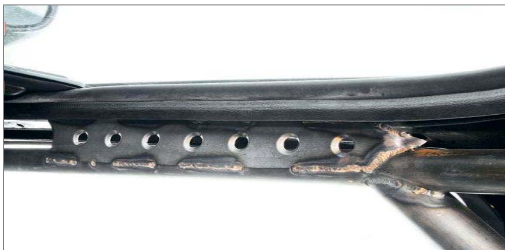
Rys. 142. Połączenie bocznego pałąka do przednich słupków pojazdu
