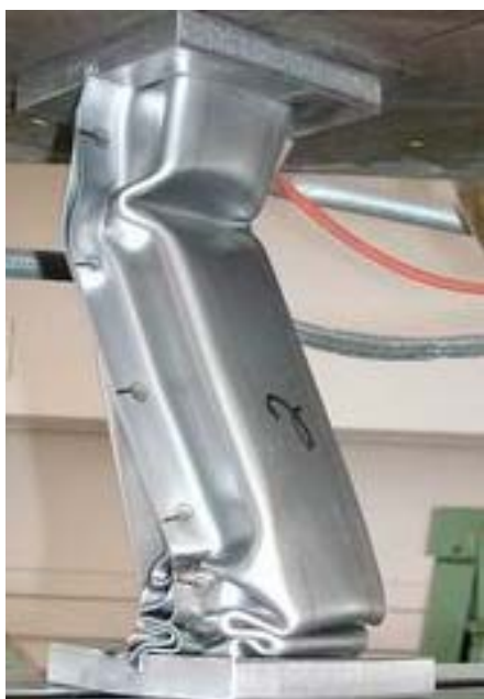
Rys. 11. Belka zgniatana: a) bez inicjatora, b) z imperfekcją wstępną [85]
