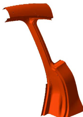
Rys. 190b. Wytłoczka zewnętrzna – model geometryczny
