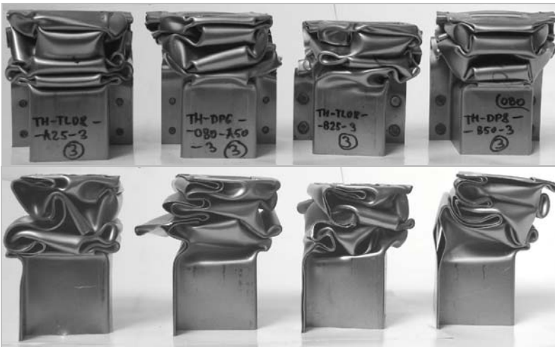
Rys. 104. Deformacja profili kapeluszkowych (widok z przodu i z boku) – grubość blachy t = 0,8 mm
