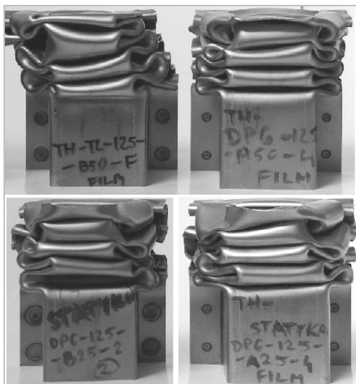
Rys. 105. Wpływ średnicy i rozstawu zgrzein na proces powstawania fal plastycznych profili TH w ramach kilku kombinacji
