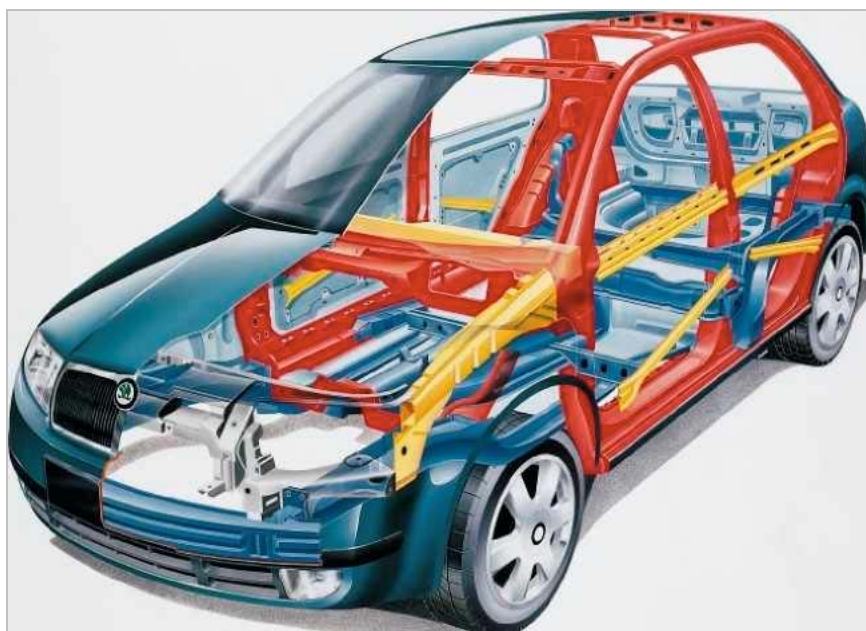
Rys. 133. Wzmocnienia boczne (kolor żółty) ścian i drzwi samochodu marki Škoda
