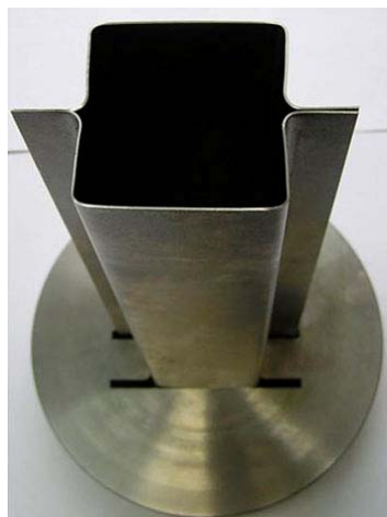
Rys. 65. Podstawa mocująca badane profile
