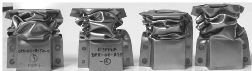
Rys. 93. Końcowa postać zgniotu belek cienkościennych – grubość blachy t = 1,25 mm: a) widok z przodu, b) widok z boku
