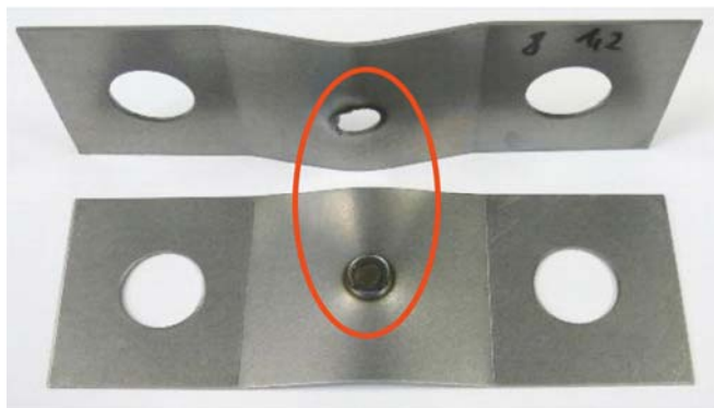
Rys. 49. Wyrwane jądro zgrzeiny punktowej z materiału rodzimego w wyniku przeprowadzonego testu krzyżowego
