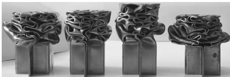
Rys. 93. Końcowa postać zgniotu belek cienkościennych – grubość blachy t = 1,25 mm: a) widok z przodu, b) widok z boku
