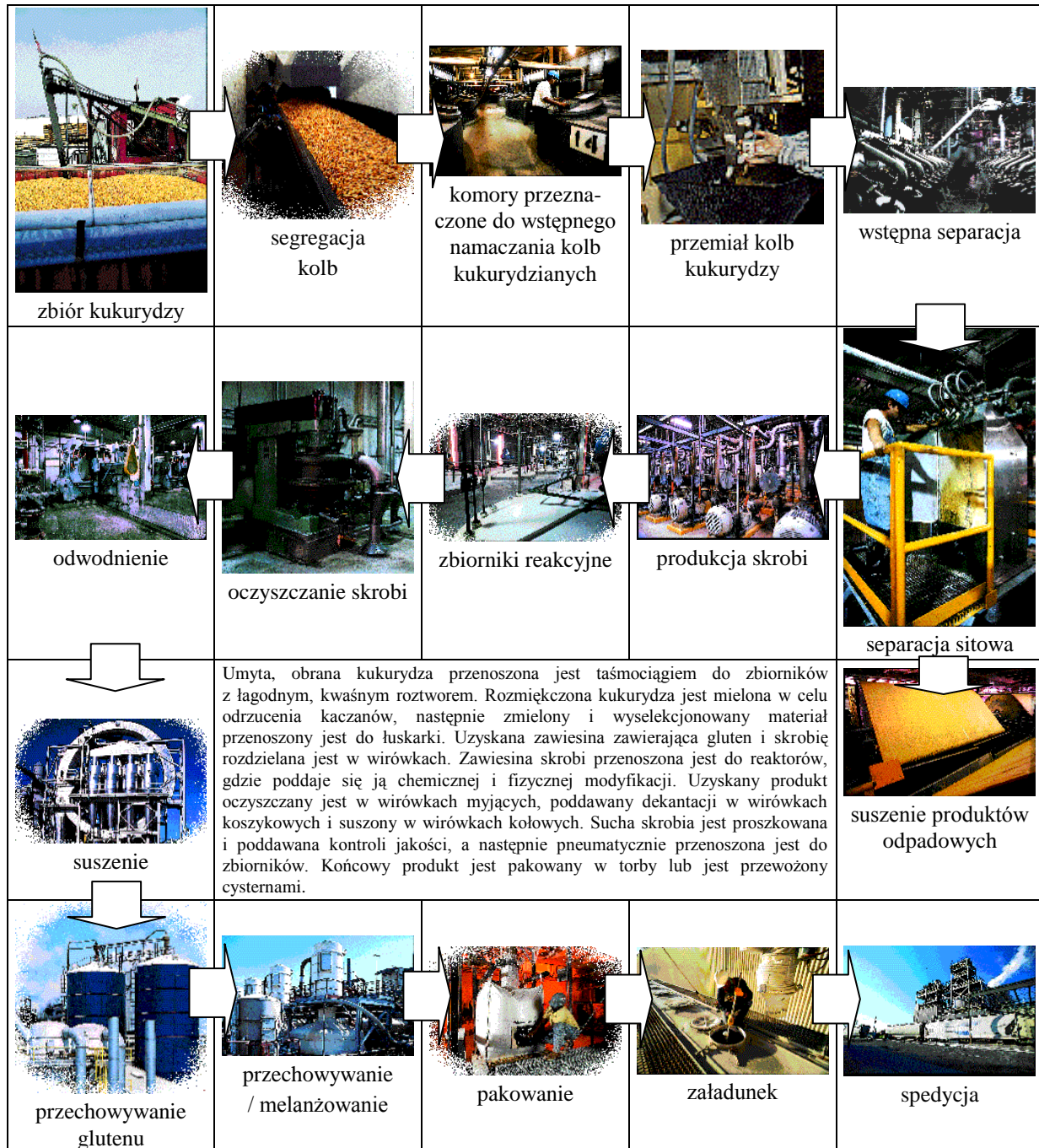
Rys. 2.11. Schemat procesu technologicznego produkcji z kukurydzy skrobi modyfikowanej (wg National Starch and Chemical Company [7]).
