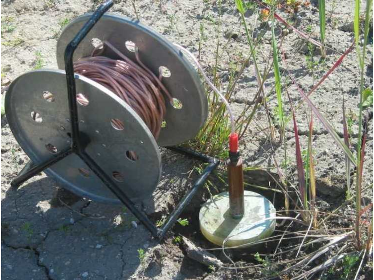
Rys. 5.16. Widok umieszczonej w gruncie elektrody do pomiaru potencjałów własnych
