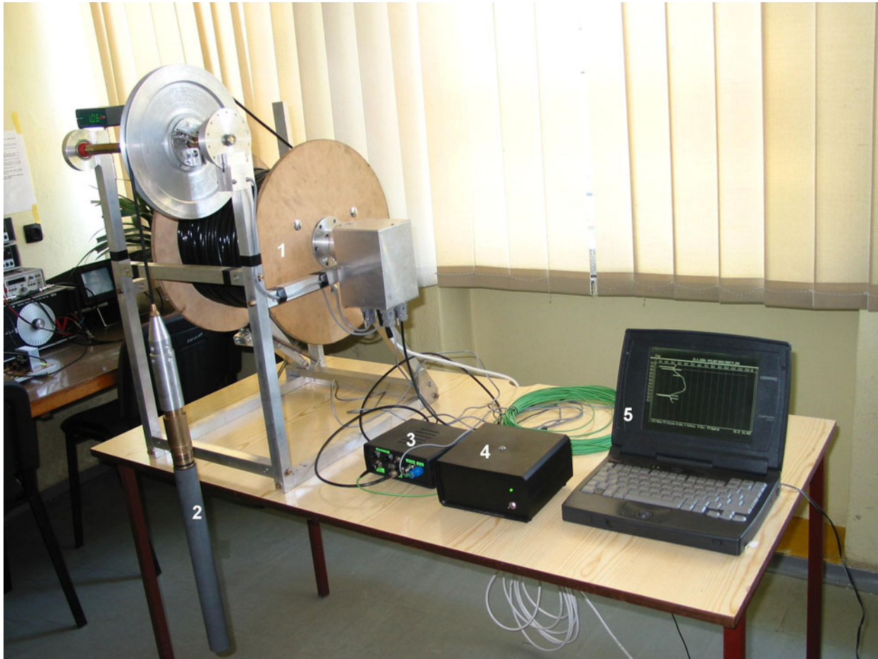
Rys. 5.9. Widok systemu pomiarowego do badania emisji elektromagnetycznej osuwisk: 1 – bęben karotażowy z przewodem światłowodowym; 2 – sonda podziemna; 3 – blok przetwarzania; 4 – odbiornik naziemny; 5 – komputer PC
