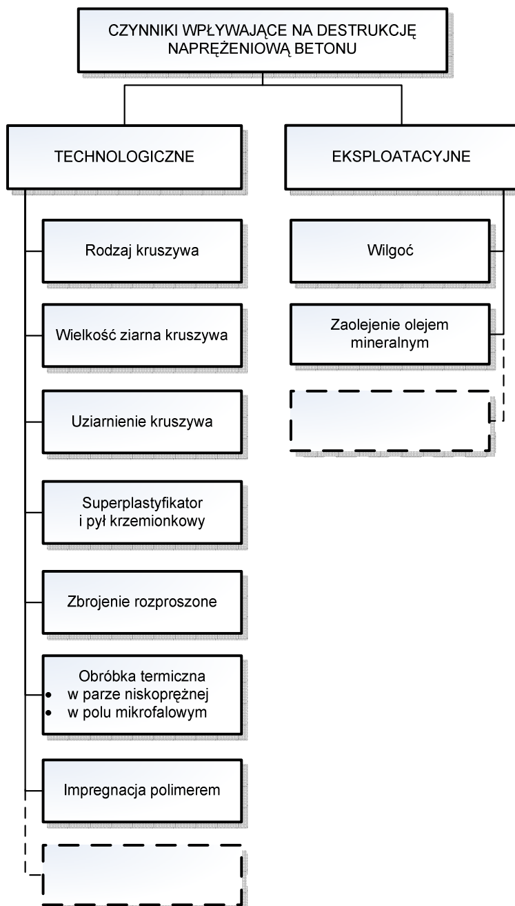
Rys. 3.3. Wybrane czynniki technologiczne i niemechaniczne czynniki eksploatacyjne wpływające na destrukcję naprężeniową betonu
