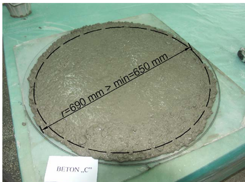
Rys. 5.1. Rezultat badania rozptywu mieszanki betonowej C za pomocą metody stożka Abramsa
