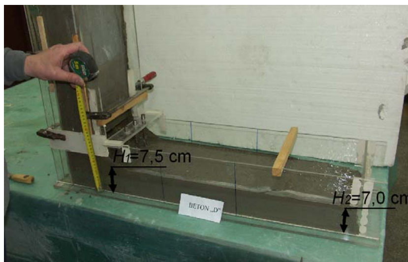
Rys. 5.3. Rezultat badania rozpływu mieszanki betonowej D w skrzynce wypływowej L-Box
