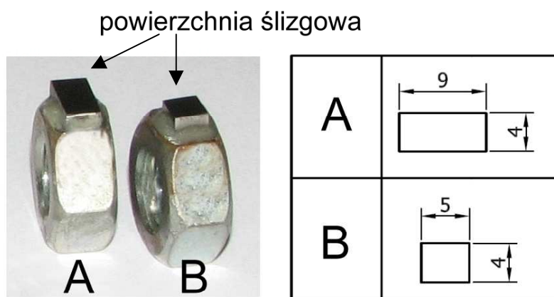
Rys. 39. Rodzaje próbek stosowanych w badaniach tribologicznych w styku rozłożonym, wraz z wymiarami powierzchni styku.
