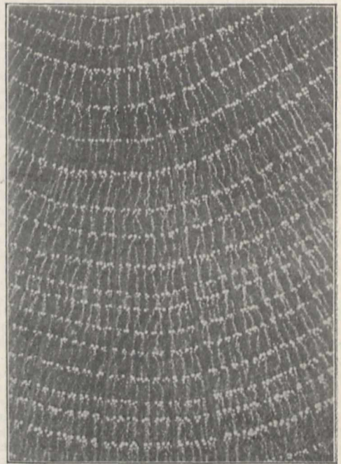
FIG. 1.—Oak. Transverse section \times 31 .
