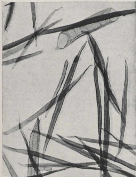
Bild 3 (links). Pappelzellstoff. Die dünnwandigen Zellen klappen zu Bändchen zusammen
