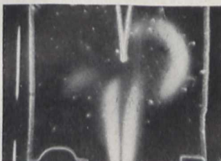
Bild 6. Anschwingvorgang einer Saitenschwingung kurz nach dem Loslassen der angezupften Saite
