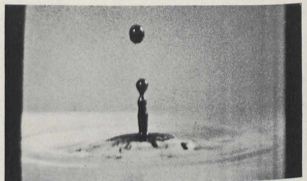
Bild 11. Aufnahme eines auf eine Wasseroberfläche fallenden geschwärzten Wassertropfens Nach dem Einfallen des Wassertropfens erhebt sich eine Wassersäule aus der Oberfläche, die sich an ihrem oberen Ende in zwei Tropfen auflöst
