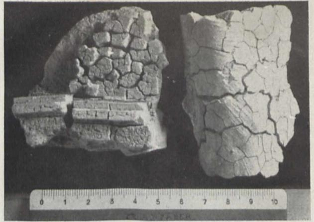
Bild 8. Gipszierat mit Treibrissen. Rotundenbrand Wien
