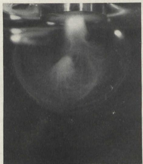
Bild 4. Blasenbildung in Glyzerin beim Schwinggerät; seitliche Ansicht. Der Blasenstrom wandert von der Mitte der Probe aus in die Flüssigkeit hinein und bewegt sich an den Rand der Probe wieder zurück
