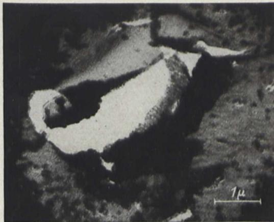
Bild 5. Oxydfilm von elektrolytisch oxidiertem Aluminium
