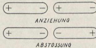
Bild 4. Kräfte zwischen Dipolmolekülen
