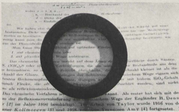
Bild 1. Eine Schrift wird durch ein Rohr betrachtet, in das 12 Glasscheiben eingelegt sind, die nur in der Mitte mit T-Belag versehen sind. Die Schrift ist gut lesbar; an dem äußeren Ring, wo der Belag fehlt, ist sie nur schwer leserlich
