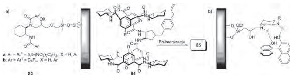
Rysunek 17. Przykłady chiralnych faz stacjonarnych opartych na wykorzystaniu DACH-u (a); oddziaływanie między BINOL-em a chiralną fazą stacjonarną (b)
