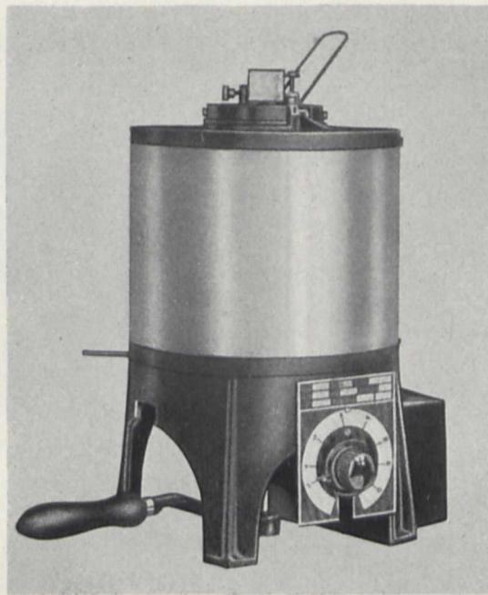
Bild 3. Tiegelofen mit selbsttätiger Temperaturregelung zwischen 500 und 1200°
