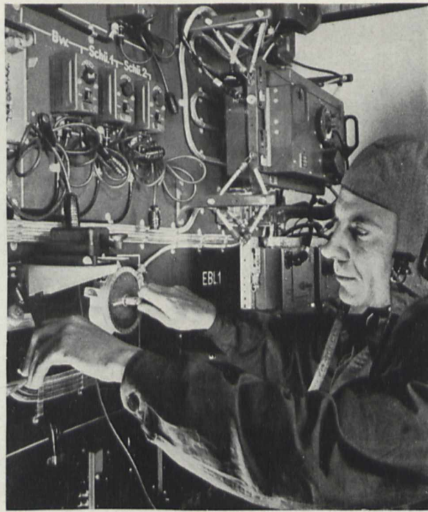
Bild 7. Vor dem Einbau der Funkgeräte für den FT-Flug werden die Geräte in der Bodenstation geprüft
