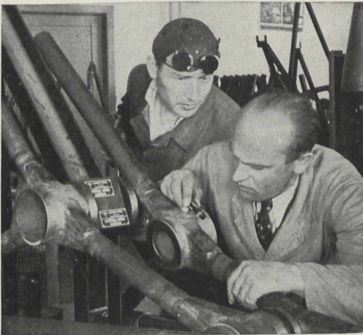
Bild 2. Die Lupe läßt die äußere Beschaffenheit der Schweißnähte erkennen. In der bereitgestellten Prüfvorrichtung wird die Austauschbarkeit untersucht
