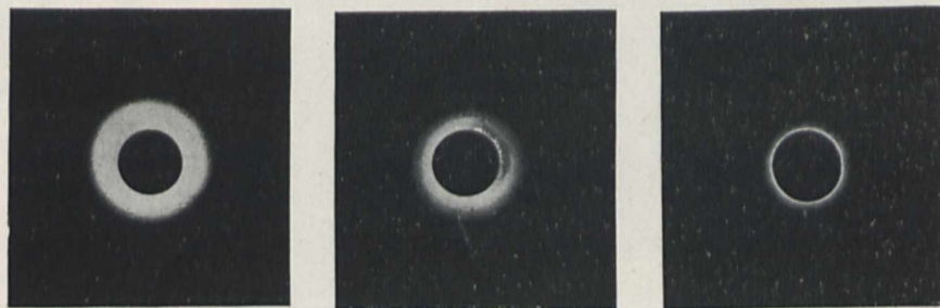
Bild 3. Streu-Aureole im Ultraroten von Meerwasser aus der Sargassogegend. a) nach einfacher Filtration, b) nach vierfacher Ultrafiltration, c) nach einer weiteren Vakuumdestillation.
