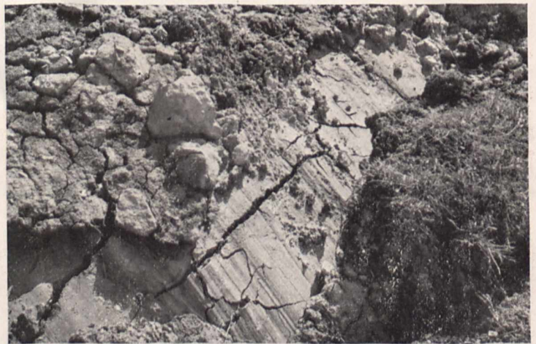
Bild 4. Rutschstreifen im Knollenmergel bei Neuler, nördlich Aalen
