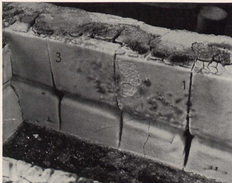
Bild 7. Versuchsofen - Seitenwand, Innenansicht. Die ausgefressenen Fugen 1 und 3 sind die Ursache der Ueberhitzungsstellen auf Bild 1
