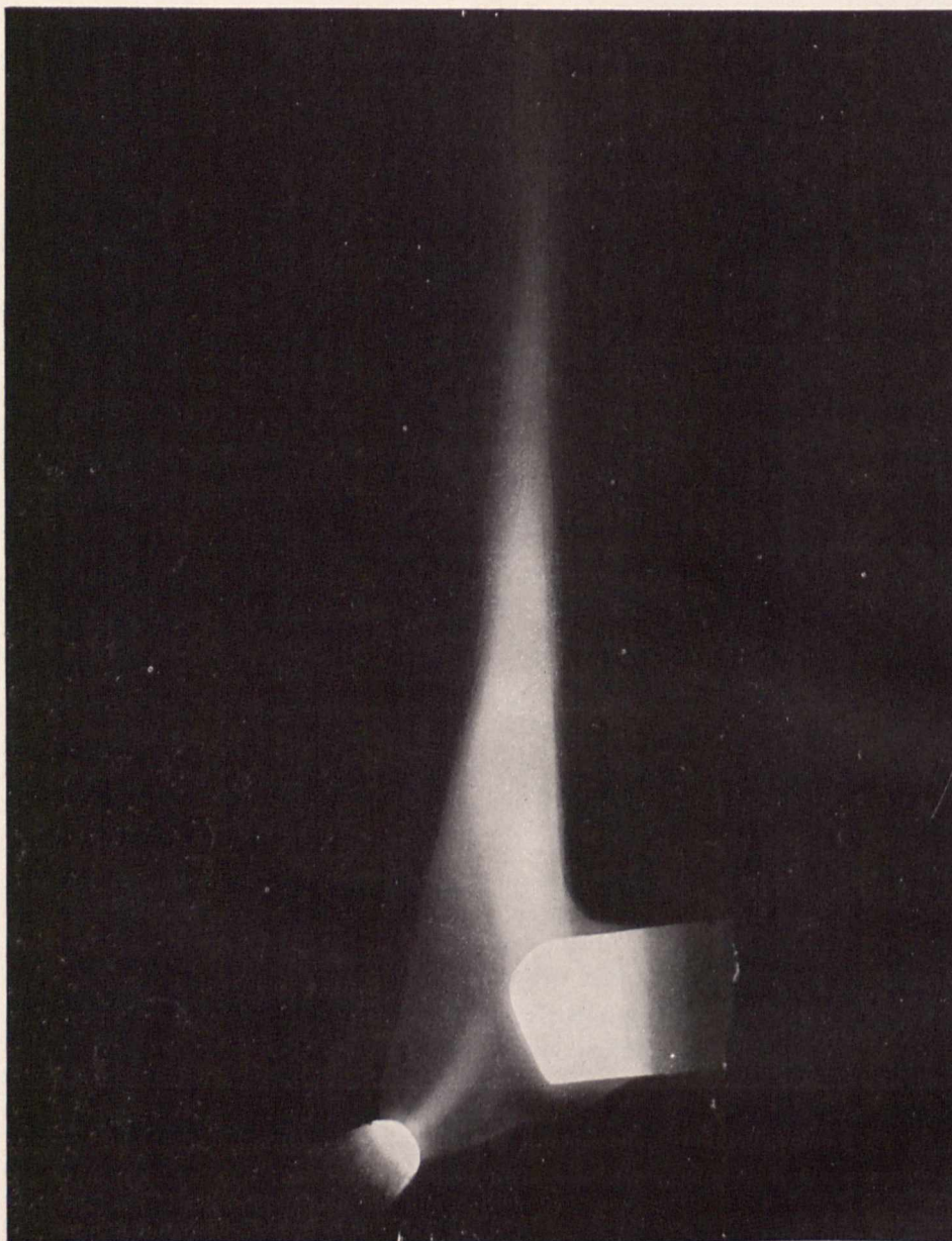
Bild 7. Beck-Lichtbogen in gewinkelter Kohlenstellung bei 120 Ampere
