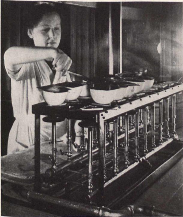
Bild 3. Die Vorveraschung. Nach 17tägiger Keimzeit werden die kleinen Roggenpflanzen zunächst in einem Vorerhitzer in Asche verwandelt
