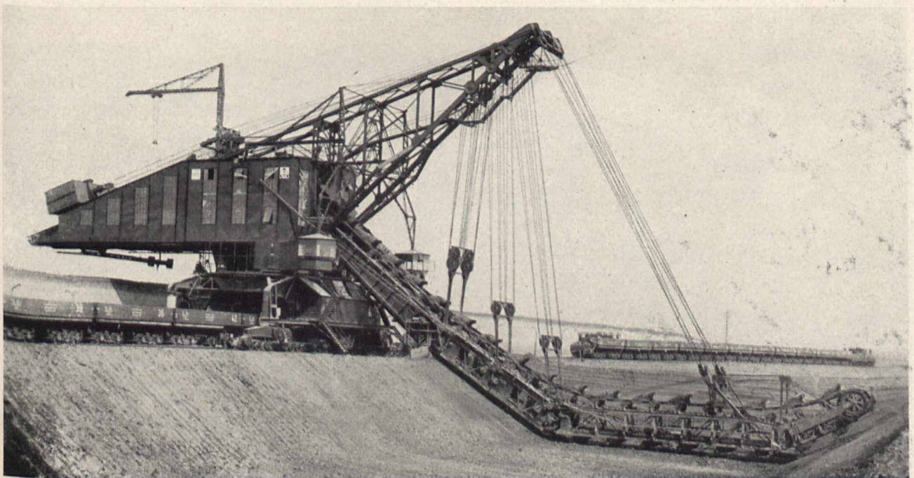
Bild 1. Abraumbagger der Grube „Göthewitz“ mit einer Leistung von 1650 m 3 /h. — Gewicht des Baggers 1200 t
