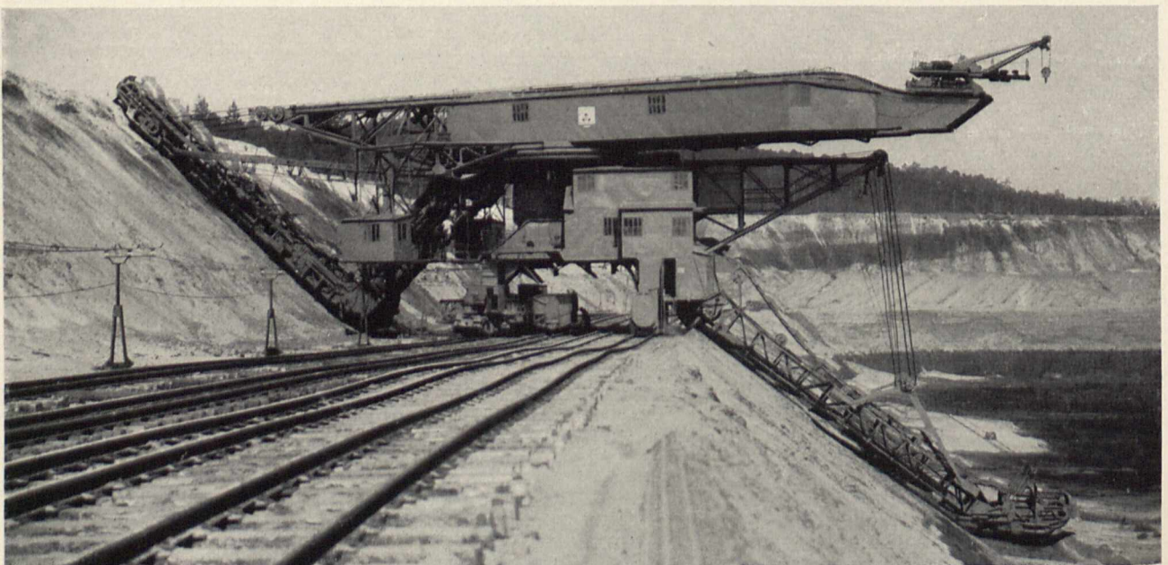
Bild 3. Verbundbagger für eine Leistung von 2000 m 3 /h in der Arbeitsstellung für den Zugbetrieb Gewicht des Baggers 600 t
