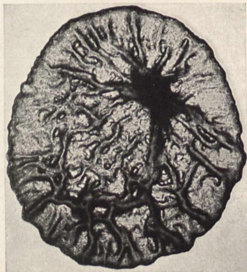
Bild 5. Oelsäuretropfen nach Einwirkung von gasförmigem Ammoniak. Trübung und starke Runzelung. Vergrößerung 10 : 1
