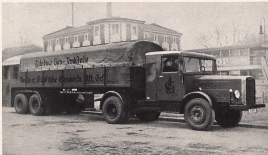
Bild 4. Fahrbare Tankstelle für Stadtgas
