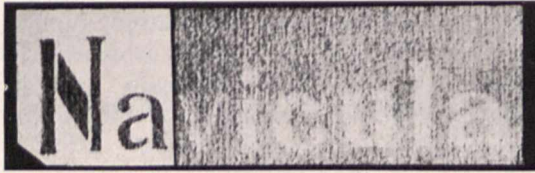
Bild 4. Rotes Haemoglobinpapier, durch drei Tage unter einer Zinkblechschablone dem Sonnenlicht ausgesetzt. — Die Buchstaben erschienen blaugrün auf rotem Grund. Die beiden ersten Buchstaben „Na“ sind mit Askorbinsäure entwickelt und färbten sich dabei gelbbraun. In der Schwarzweißwiedergabe erscheinen sie kontrastreich schwarz auf weißem Grund, die nicht entwickelte Buchstabenfolge „vicula“ dagegen weiß auf dunklem Grund
