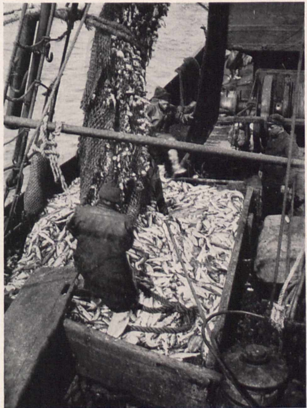
Bild 3. Der Inhalt des Netzes ist auf das Deck des Fischdampfers entleert worden. — Der Netzbeutel hängt noch am Mast und wird zum erneuten Aussetzen wieder durch einen Knoten verschlossen. Der Fang beträgt hier etwa 100 Korb (= Zentner); er kann in 2—3 Stunden gelegentlich mehrere hundert Korb erreichen
