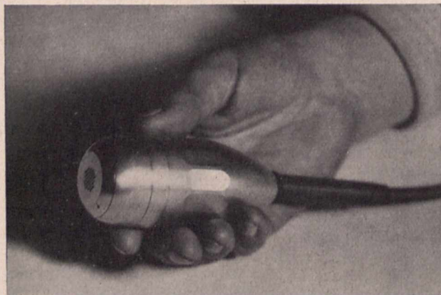
Bild 1. Das Kondensormikrophon, wie es auch bei Großaufnahme-Apparaturen verwandt wird, hat mit dem Verstärkerrohr diese geringen Ausmaße
