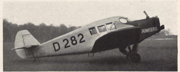
Bild 4. F 13, das 1919 entstandene einmotorige Junkers-Verkehrsflugzeug, das s. Z. das meist verwendete Flugzeug der Welt war — in über 22 Staaten eingeführt — und wovon das erste im Luftverkehr eingesetzte 14 Jahre Dienst tat.
