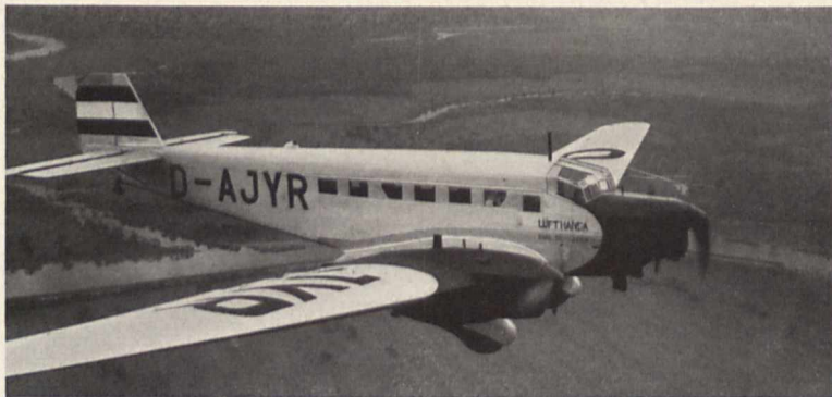
Bild 5. Ju 52, das meistverwendete Verkehrsflugzeug der Welt. — Das hier abgebildete Flugzeug ist mit dem ersten Schweröl-Flugmotor der Welt, Jumo 205, ausgerüstet
