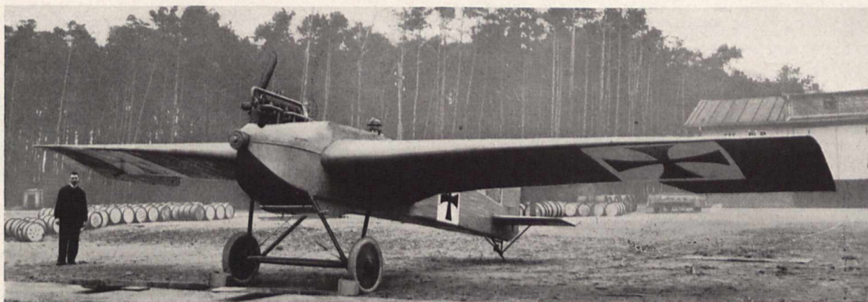
Bild 2. Junkers J 1-Flugzeug aus Eisenblech, das hier als „tragende Haut“ erstmals im Flugzeugbau verwendet wurde (1915). Hier wurde noch nicht die Tiefdeckerbauart angewendet Werk-Photo
