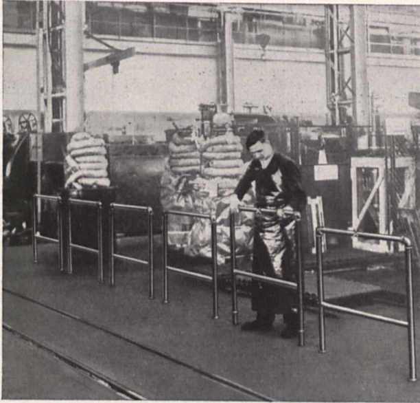
Bild 3. Einsteckgitter zur Sicherung des Transportweges
