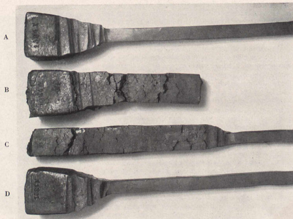
Bild 3. Einfluß des Wasserstoffs auf die Verschmiedbarkeit des Stahles Erklärung im Text
