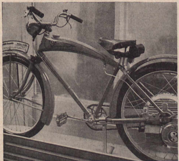
Bild 5. Das „motorisierte Hinterrad“. Schon vor einem Jahr hörte man davon — jetzt ist es lieferbar. Hier sehen wir den Motor in einem Spezialrahmen, bei dem das obere Rohr als Tank ausgebildet ist. — Victoria-Saxonette
