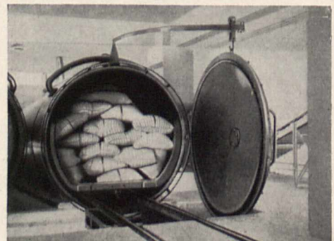
Bild 3. Vakuum-Begasungsanlage für Kakao (Bahia)
