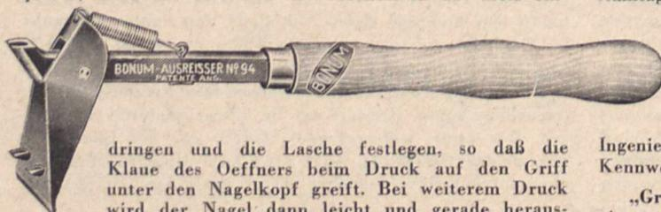
dringen und die Lasche festlegen, so daß die Klaue des Oeffners beim Druck auf den Griff unter den Nagelkopf greift. Bei weiterem Druck wird der Nagel dann leicht und gerade herausgezogen. Ein Hammer ist nicht mehr erforderlich. Alle Sorten Nägel lassen sich leicht herausziehen. Im übrigen ist die Lasche als Kistenschaber ausgebildet, zum Entfernen der Signatur usw. T. Bl.
