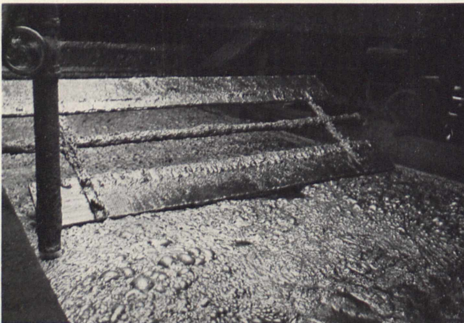
Bild 4. Flotationsbottich mit obenauf schwimmendem Graphit
