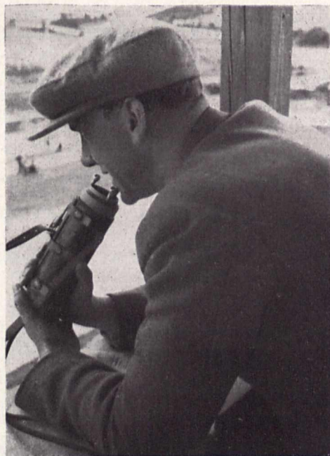
Bild 6. Spezialmikrophon für Uebertragung aus lärmgefüllter Umgebung
