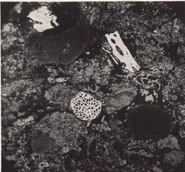
Bild 1. Braunkohlenstaub der deutschen Weichbraunkohle, Grube Klara, Niederlausitz. Dunkelgrau: rundliche Harzkörper. Nahe der Mitte eine Pildauerspore (Sklerotium). Staubanschliff (Preßschliff); unter Oel 400mal
