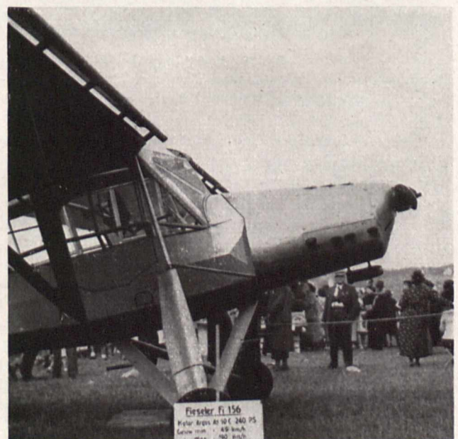
Bild 1. Der „Storch“. — Man beachte den vorgeschobenen Spaltflügel, die Fahrwerkskonstruktion und die Befestigung der V-Strebe des Flügels am Rumpf, über deren Befestigungspunkt der Flügel nach rückwärts geschwenkt wird
